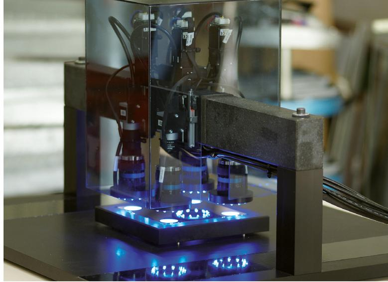
Durch das Auslesen von Passermarken erkennen die Kameras des Warpinspectors Siebverzüge im Mikrometerbereich.
