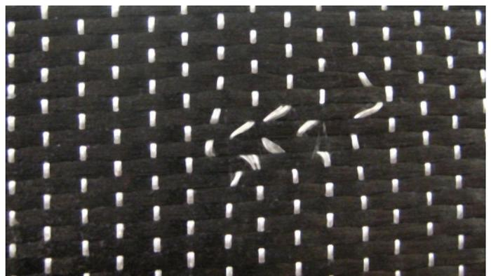
Typischer Fehler, der bei der manuellen Inspektion häufig übersehen wird. Verzogene Kettfäden in der Bahn eines Kohlefasergeleges.
