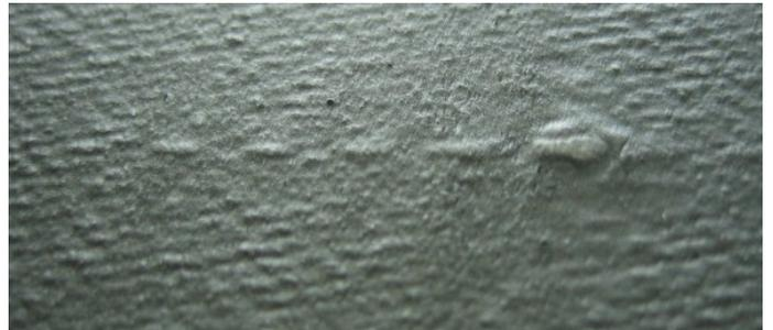
Erkannte Fadenverdickung nach der Beschichtung
